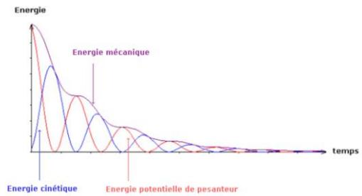
L'énergie mécanique diminue au cours du temps
